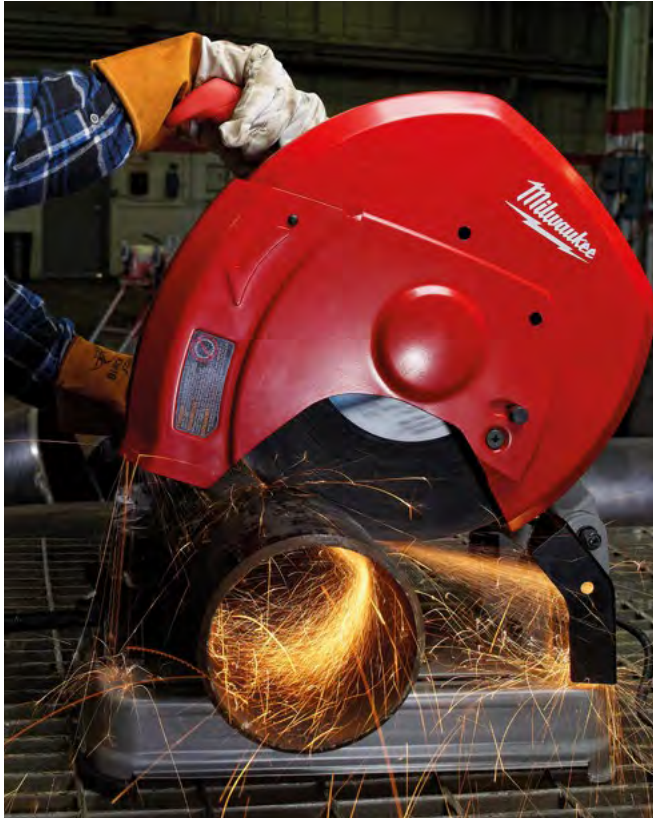
SIERRA TRONZADORA 14" 15 Amp 3,900 RPM #6177-20 (021558)
