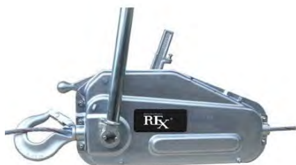
TRACTEL DE CABLE (WINCHE) 6 ton (021473)
